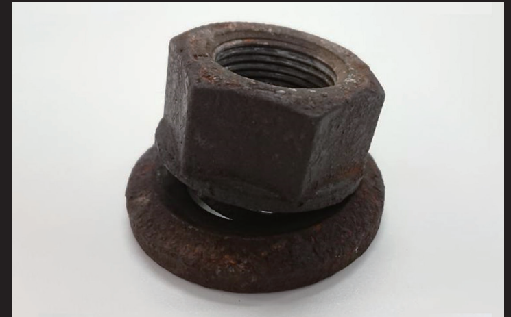
ホイールナットとワッシャーに変形が見られ、ワッシャーがはずれかかっている。
