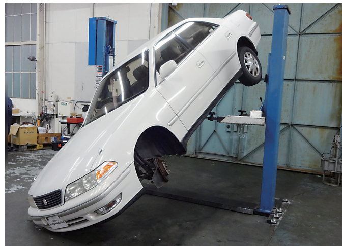
荷重バランスが悪い状況でのリフトアップによる車両落下検証実験写真
